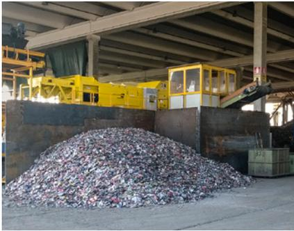
In der Anlage Steinert XSS werden per Röntgentransmission Schwer- von Leichtmetallen getrennt. Foto: Steinert
