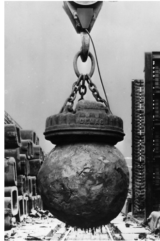
Fallwerk mit Spezialmagnet und Fallkugel
